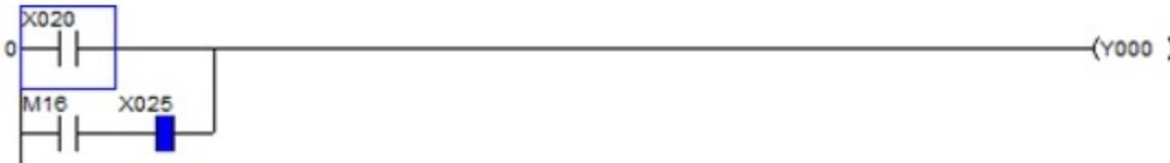
Part diatas merupakan bagian yang digunakan untuk menyalakan atau mengenergized sistem (Latch) agar sistem tetap menyala. Di sini X020 merupakan Power Button.
